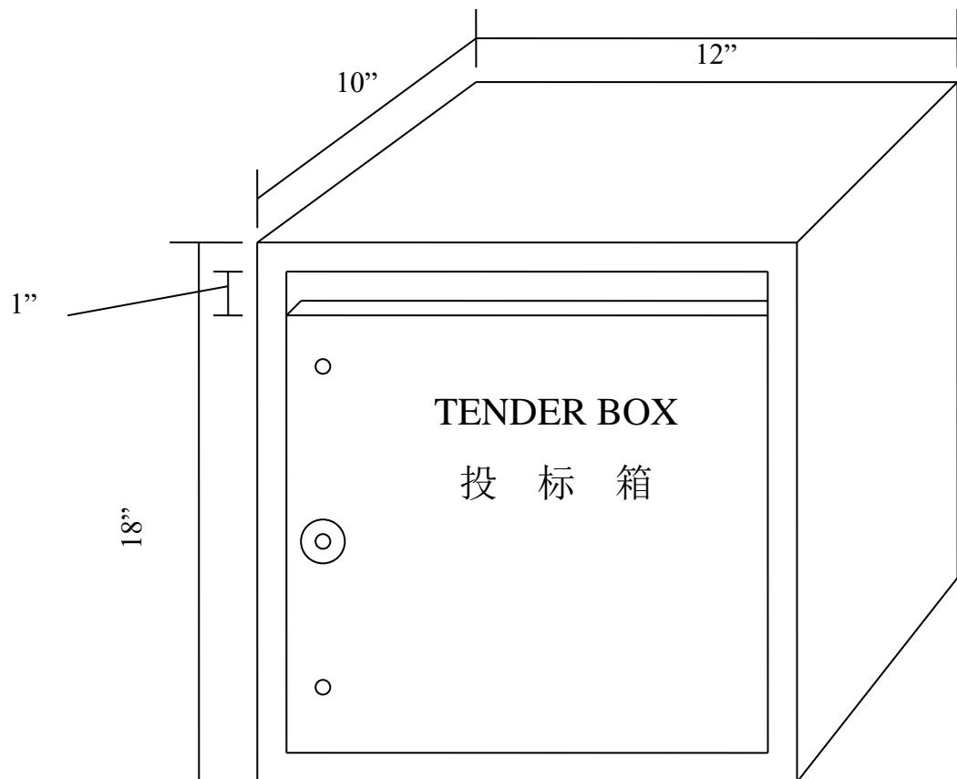
体积： 12吋(阔)×18吋(高)×10吋(深)，正面开设一个1吋×12吋的信封入口。
